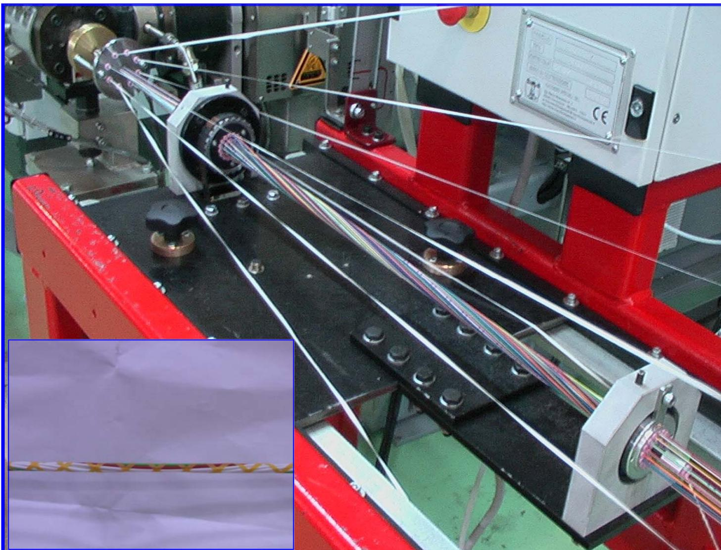
**Ligne apte à réunir micro-câbles à pas alternés S-Z , composés par fibres optiques avec isolement tight ou conducteurs traditionnels.**
